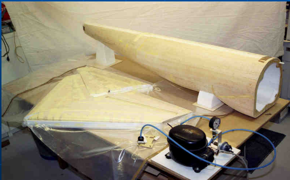
Fertigstellung der Baueinheiten Vaccumieren der Höhen- und des Seitenruder
