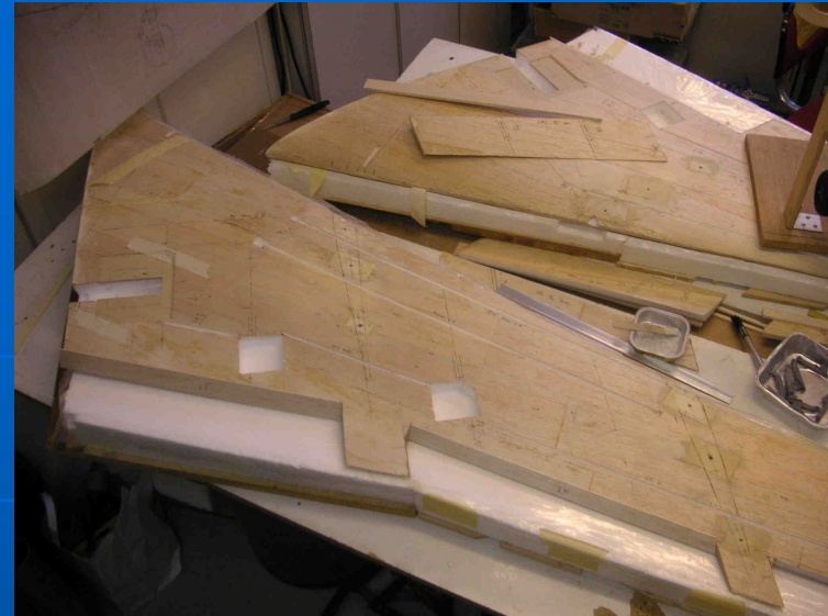
Öffnungen für Servokästen Einlegen der Servo- und Impellermotoren- Kabel
