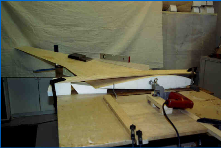
Genaueres bohren der Haupt-Flügelhalterung mit improvisierter Bohrmaschinen-Führung Genauere Ausrichtung mit Wasserwaage und Verleimung der Rohrhalterungs-Büchsen
