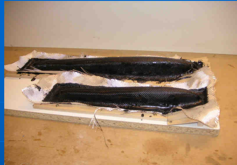
Negativ Form mit GFK-Abguss Notwenige Teile für die Abdeckungen
