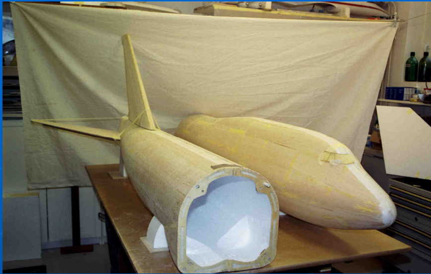
Fertigstellung der Baueinheiten Vaccumieren der Höhen- und des Seitenruder
