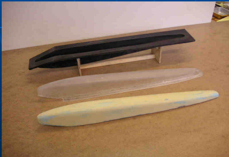
Urform für die Landklappen-Gelenk-Abdeckung Urform, Negativ-Form mit fertigem Abguss
