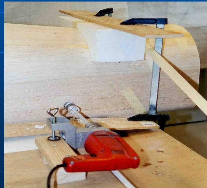
Genaueres bohren der Flügel-Rohrhalterung
