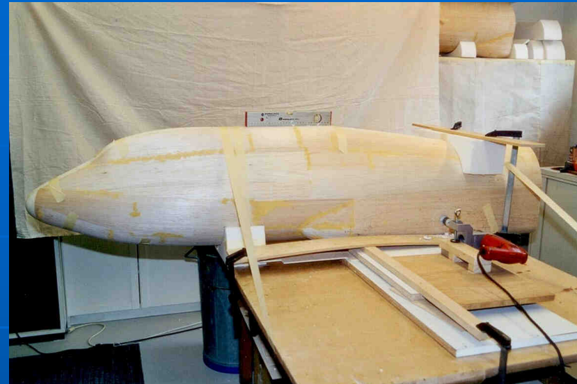
Genaueres bohren der Flügel-Rohrhalterung
