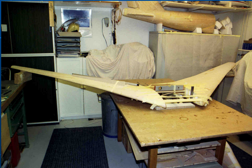
Genaueres bohren der Haupt-Flügelhalterung mit improvisierter Bohrmaschinen-Führung Genauere Ausrichtung mit Wasserwaage und Verleimung der Rohrhalterungs-Büchsen
