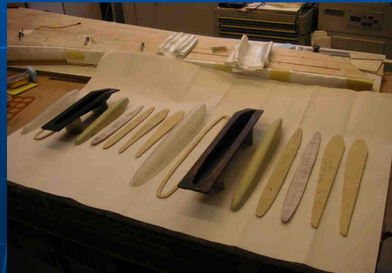
Negativ Form mit GFK-Abguss Notwenige Teile für die Abdeckungen
